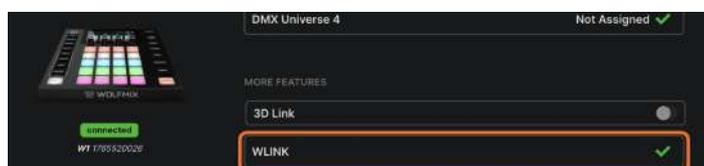
Une fois que l'extension WLINK a été activée, connectez un câble de votre carte de fader DMX à la prise WLINK à 5 broches. Selon le câble, vous aurez peut-être besoin d'un adaptateur XLR mâle-mâle.
