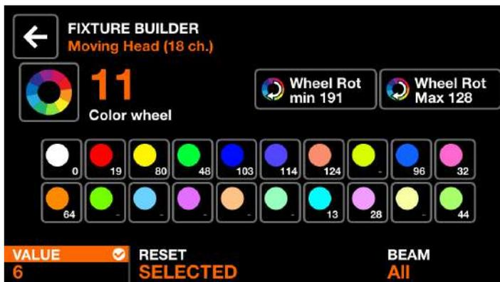
Le fait d'appuyer sur le deuxième encodeur réinitialise la couleur. Si vous avez un appareil avec plusieurs faisceaux, choisissez le faisceau associé avec le 4ème encodeur.
