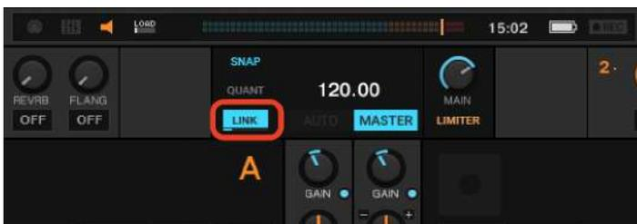
Pour OS2L, il y a une étape supplémentaire : configurez Virtual DJ avec l'adresse IP 127.0.0.1 et le port 5000 pour établir la connexion (ex. 127.0.0.1:5000). Nous avons constaté que parfois WTOOLS doit être lancé avec OS2L activé avant de lancer Virtual DJ.
