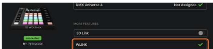
Une fois que l'extension WLINK a été activée, connectez un câble XLR mâle - mâle à 5 broches à la prise WLINK de chaque Wolfmix. Nous fournissons un câble WLINK officiel pour cela. Le câble peut être prolongé avec un câble XLR DMX standard à 5 broches.
