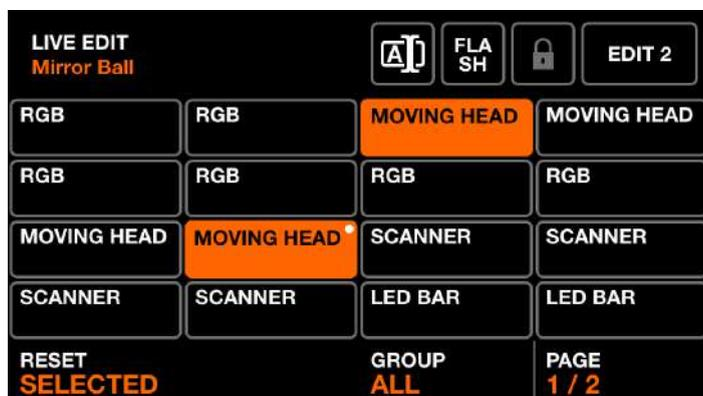
Si un appareil a été modifié, un point blanc apparaîtra dans le coin du bouton de l'appareil. Appuyez sur le premier encodeur pour réinitialiser les appareils sélectionnés.
